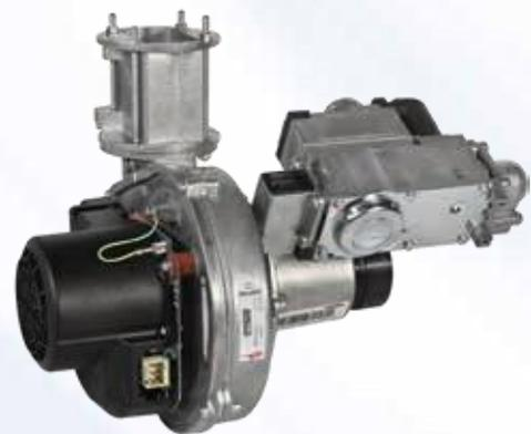
С модулированным вентилятором марки EBM обеспечивается необходимое количество газозоудной смеси в зависимости от мощности котла. Скорость вентилятора увеличивается или уменьшается в зависимости мощности. Таким образом сохраняется как низкий уровень шума, так и отсутствие потери эффективности из-за избытка воздуха.
